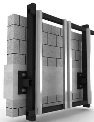
جزئیات اجرای پروفیل های گالوانیزه به فاصله ۶۰ سانتی متر به صورت عمودی روی سازه فلزی
