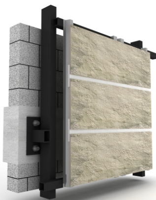
اجرای سمنت برد طرح سنگ به صورت نواری . سمنت برد دوبل به عنوان بند
