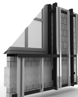
جزئیات شاسی کشی و پروفیل گالوانیزه و فلاشینگ در محل بازشو
