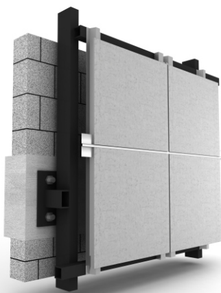
اجرای سمنت برد و پروفیل گالوانیزه A به عنوان بند افقی و عمودی
